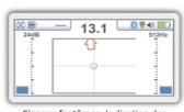
Signaux fantômes- Indication des signaux fantômes et flèche de guidage jusqu'à la sonde
